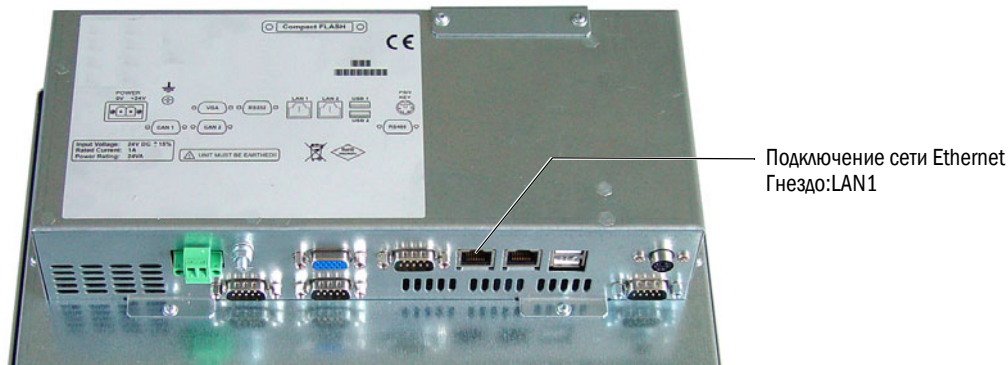
Рисунок 7 Подключение сети Ethernet на задней стороне панели управления
